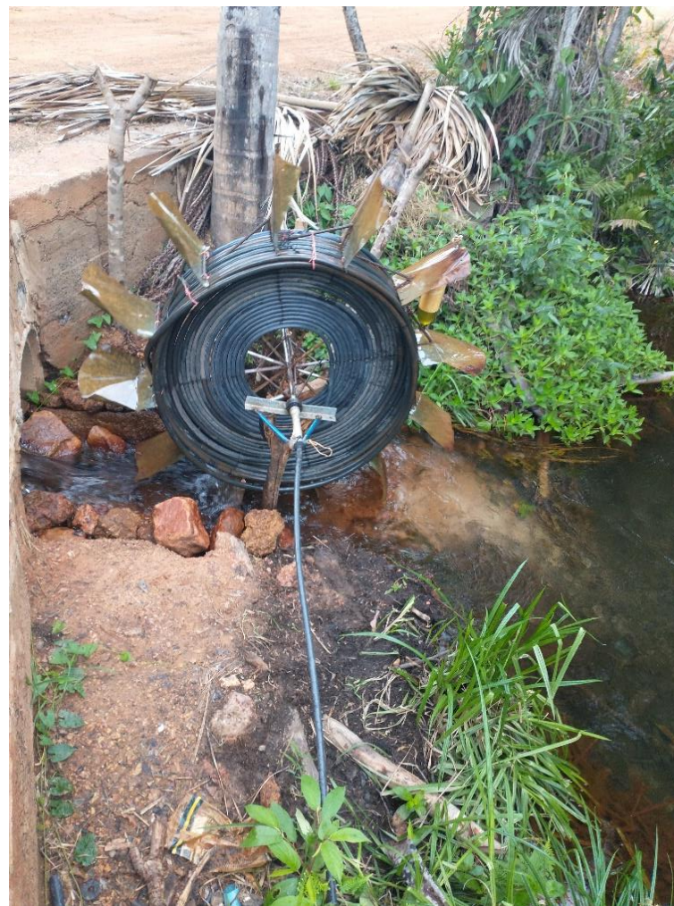
Figura 9 - Tecnologia social: roda de água feita com mangueiras de forma artesanal pelos geraizeiros na comunidade de Larga, São Desidério, BA. Rigonato, 2021.
