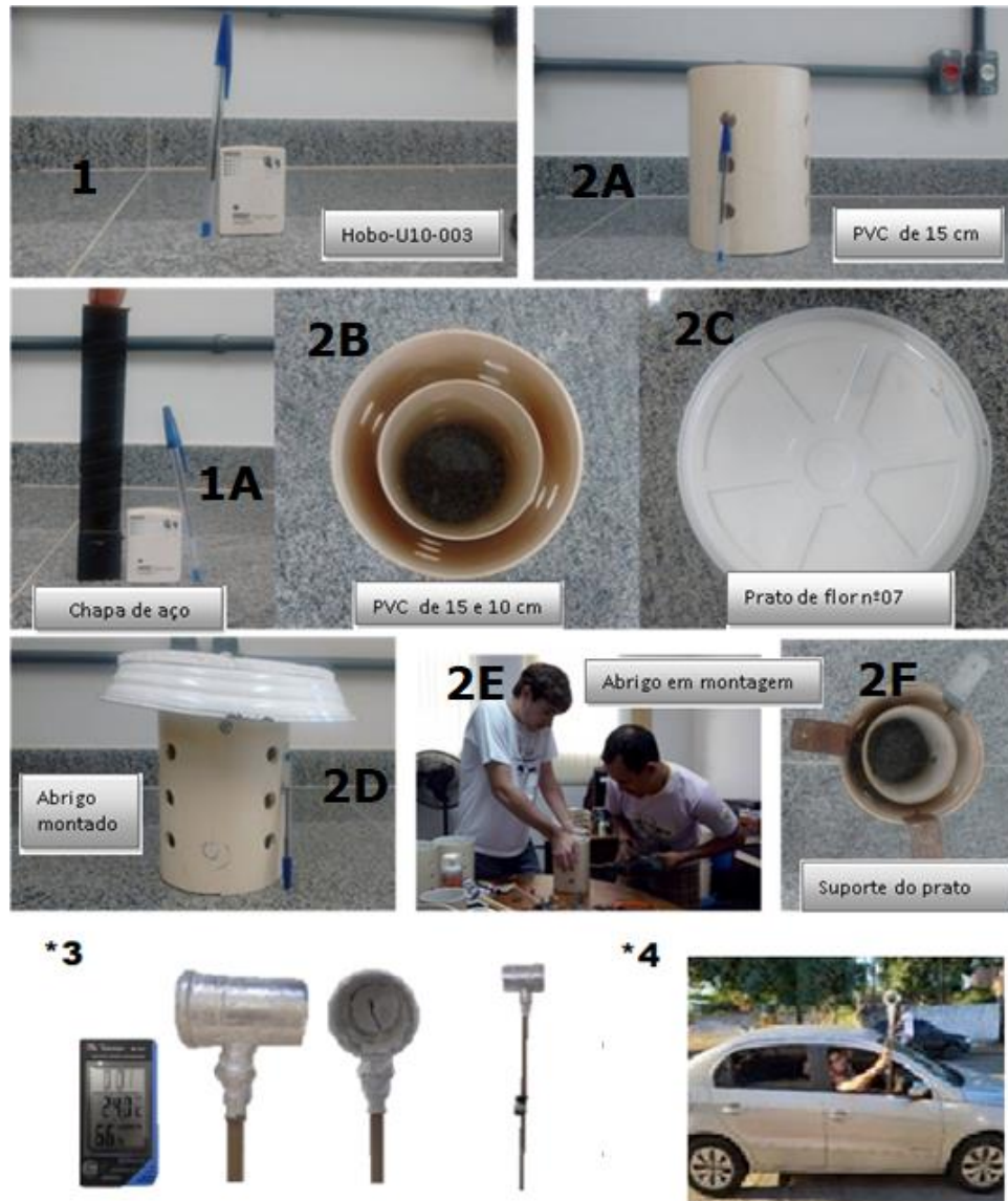
Figura 4 - Equipamentos utilizados no transect móvel e pontos fixos.
